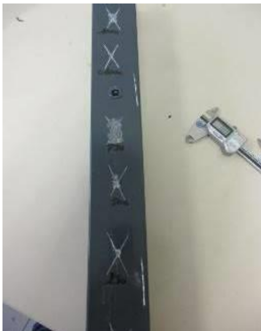
S22-042 : 耐乐福Nylofor® 3D 网片折弯处 1000h 盐雾试验后
